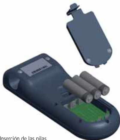
Fig. 2. Inserción de las pilas
